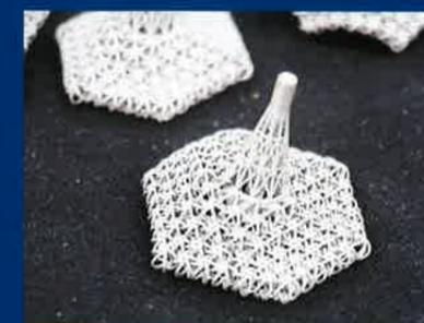
【3Dプリンティングならではの加工品(金属編み込み素材)】
