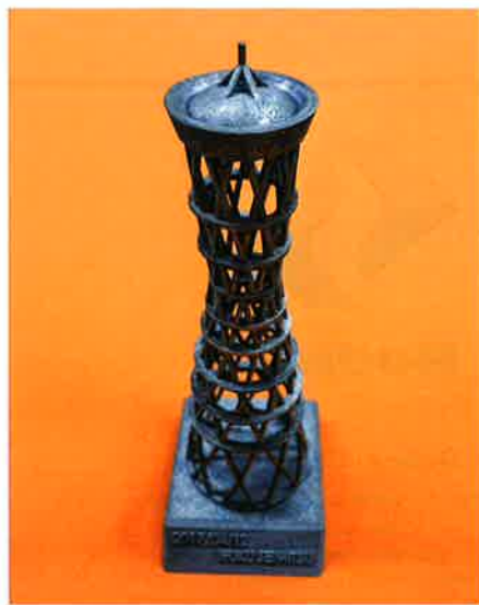
出处：伊福精密株式会社 利用金属三维打印机加工的产品“神户灯塔”
